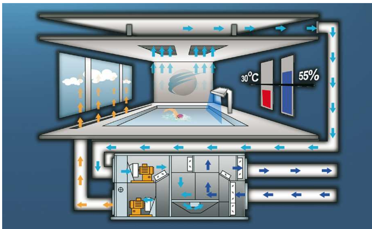
Rys. 1 Schemat funkcjonalny instalacji klimatyzacyjnej dla hali basenowej
